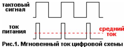
Рис.1. Мгновенный ток цифровой схемы
