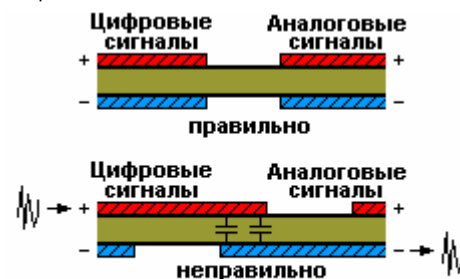
Рис.1. Размещение полигонов аналоговых и цифровых сигналов
