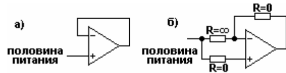
Рис.20. Правильное подключение выводов неиспользуемого ОУ
