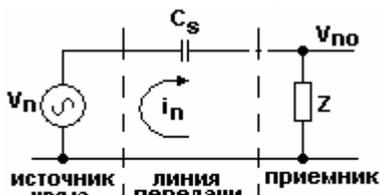
Рис.2. Эквивалентная схема емкостной связи между источником и ближайшим сопротивлением
